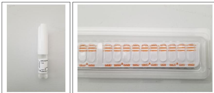
Figure 11 : Photographie de l'ampoule AUX Medium (à gauche) et de la galerie API 20NE avant ensemencement (test d'assimilation : de GLU à PAC) (à droite).
