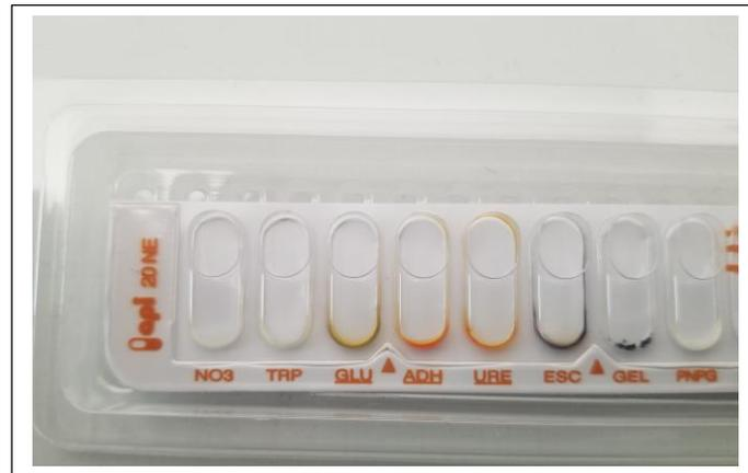
Figure 10 : Photographie de la galerie API 20NE avant ensemencement (tests conventionnels : de NO<sub>3</sub> à PNPG).
